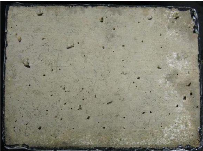
Abbildung 6: Oberfläche des Betons der Serie XF4 nach 56 Frost-Tau-Wechseln. Taumittel: Ice & Dust-Away Plus (Originallösung) (Untersuchungsbericht Frost-Taumittel-Prüfung, Universität Duisburg-Essen, Institut für Materialwissenschaft, 2015)
